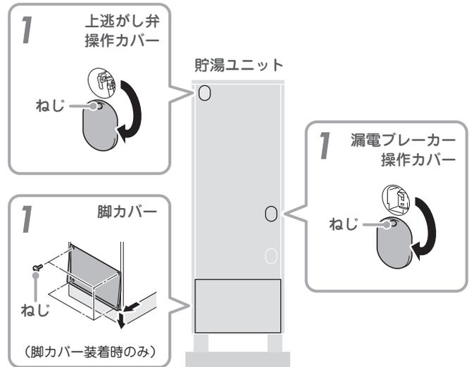
2 漏電ブレーカーの電源レバーを「OFF」にする。
