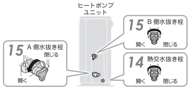
**16** 水抜きが終わったら、逃がし弁のレバーを閉じる。
