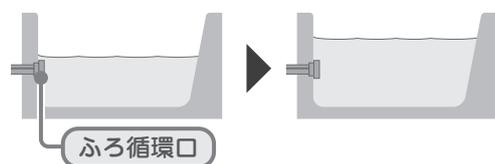
お風呂の残り湯の水位が、ふろ循環口より上にあるときは、設定されたふろ湯量の不足分をたし湯し、設定温度まで沸き上げて保温します。
