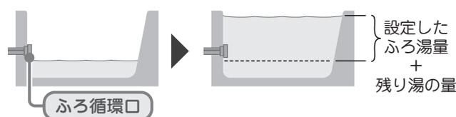
お風呂の残り湯の水位が、ふろ循環口より下にあるときは、お風呂の残り湯の量だけお湯が増えます。あふれるようでしたら、ふろ自動運転をする前に、残り湯を排水してください。
