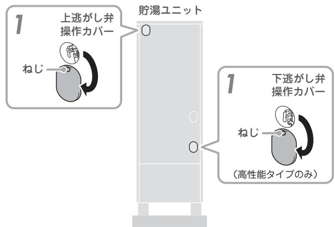
**2 逃がし弁のレバーを2～3回開閉する。**
