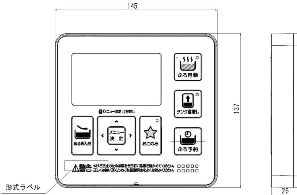
リモコン取付台寸法図 (裏面)
