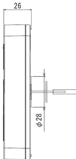
リモコン取付台寸法図 (裏面)
