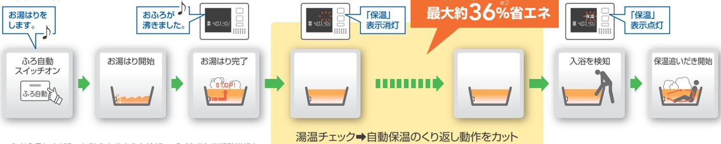
※1. お風呂に人が入った時の水位変化を検知。※2. (条件)：高断熱浴槽を使用。・外気温度7℃、お湯はり量180L、お湯はり温度40℃、ふろ配管架橋ポリエチレン管13A-6m、断熱材厚さ10mm。お湯はり完了後、2時間保温運転中に2人入浴を想定した場合の比較。省エネ保温1,900kJ/従来保温2,950kJの比較。
