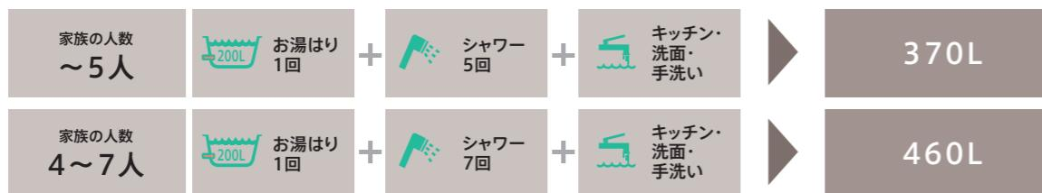
※一般地における塩害地です。●ご注意:水道水を使用してください。温泉水や井戸水は使用不可です。また、水道水であっても塩分、石灰分、その他不純物が多く含まれている場合や、酸性水質の地域では、使用を避けてください。水経路の詰まり、腐食などにより故障の原因となる場合があります。●お湯はり温度設定40℃、シャワー・湯量毎分10Lで8分使用。(貯湯ユニット内温度85℃・給水温度5℃) ●使用湯量は連続給湯の目安であり、使い方などにより変わります。●2世帯住宅などでお風呂が2ヵ所にある場合、2台のエコキュートが必要になります。
