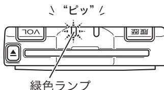
3. ETCカードの確認が終了すると緑色ランプが点灯し、ブザー音が“ポーン”と鳴り、「ETCカードが挿入されました。」と音声案内します。また、アンテナのETCカード挿入確認ランプ<緑>が点灯します。
