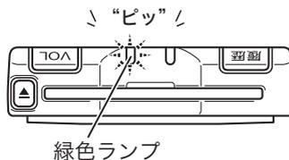
4. ETCカードの確認が終了すると緑色ランプが点灯し、ブザー音が“ポーン”と鳴り、「ETCカードが挿入されました。」と音声案内します。また、アンテナのETCカード挿入確認ランプ<緑>が点灯します。
