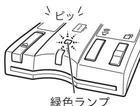
4. ETC カードの確認が終了すると緑色ランプが点灯し、ブザー音が“ポン”と鳴り、「ETC カードが挿入されました。」と音声案内します。また、アンテナの ETC カード挿入確認ランプく緑>が点灯します。
