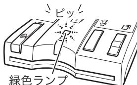
3. ETCカードの確認が終了すると緑色ランプが点灯し、ブザー音が“ポン”と鳴り、「ETCカードが挿入されました。」と音声案内します。また、アンテナのETCカード挿入確認ランプ<緑>が点灯します。
