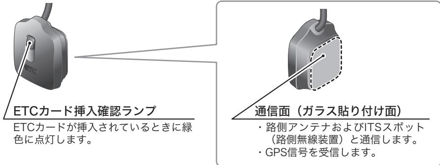
ETCカード挿入確認ランプは、車種や取り付け位置、インナーミラー やドライビングポジションの調整、天候などにより見えにくくなる場合があります。
