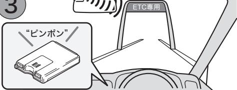
そのまま進むと、ETC2.0車載器と路側アンテナ間で、必要な情報が通信されます。
