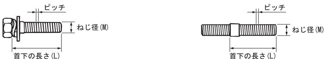
例：ねじ径 mm、首下の長さ10 mmのボルトは、M6×L10と表します。
