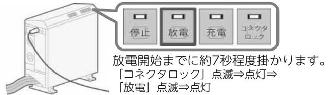
7 準備が完了し**給電可能**となる。使用する電気設備の電源を入れてください。
