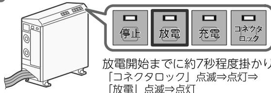
※コネクタ接続から5分以内に自立運転を開始できなかった場合は車両からの起動用給電が停止します。この場合、充放電コネクタを挿し直してから、再度放電ボタンを押してください。
