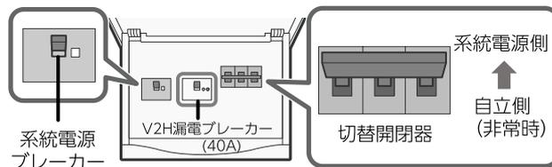
※模擬停電終了の際は系統電源ブレーカーを「ON」にする。
