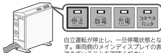
自立運転が停止し、一旦停電状態となります。車両側のメインディスプレイの表示が消えていることを確認ください。
